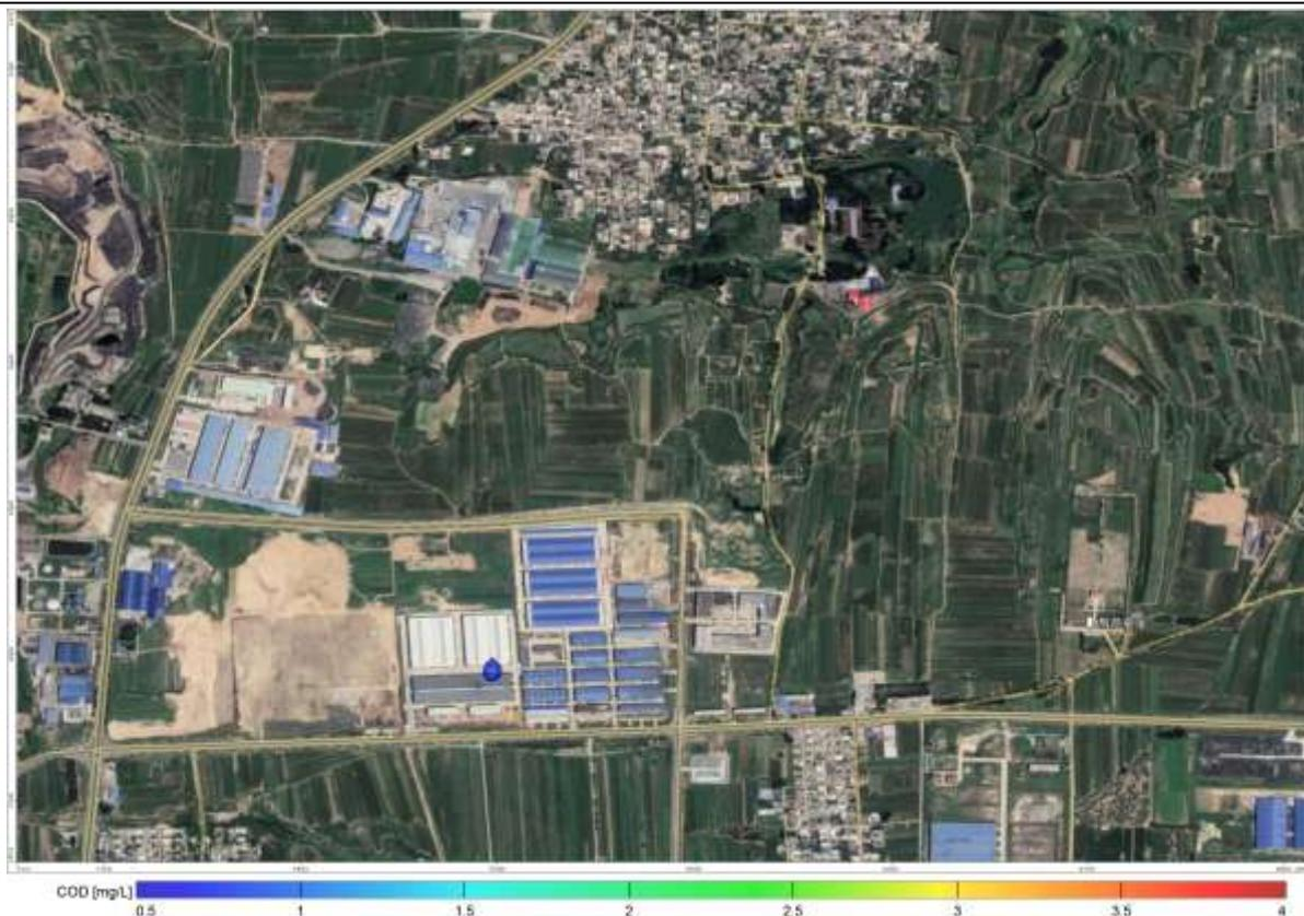
图 5-15 渗漏 100d 地下水中 COD 运移预测图
