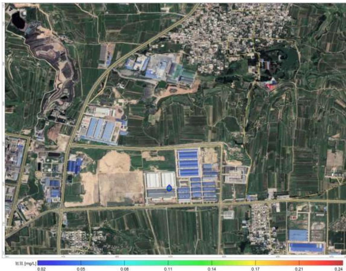
图 5-20 渗漏 100d 地下水氨氮运移预测图
