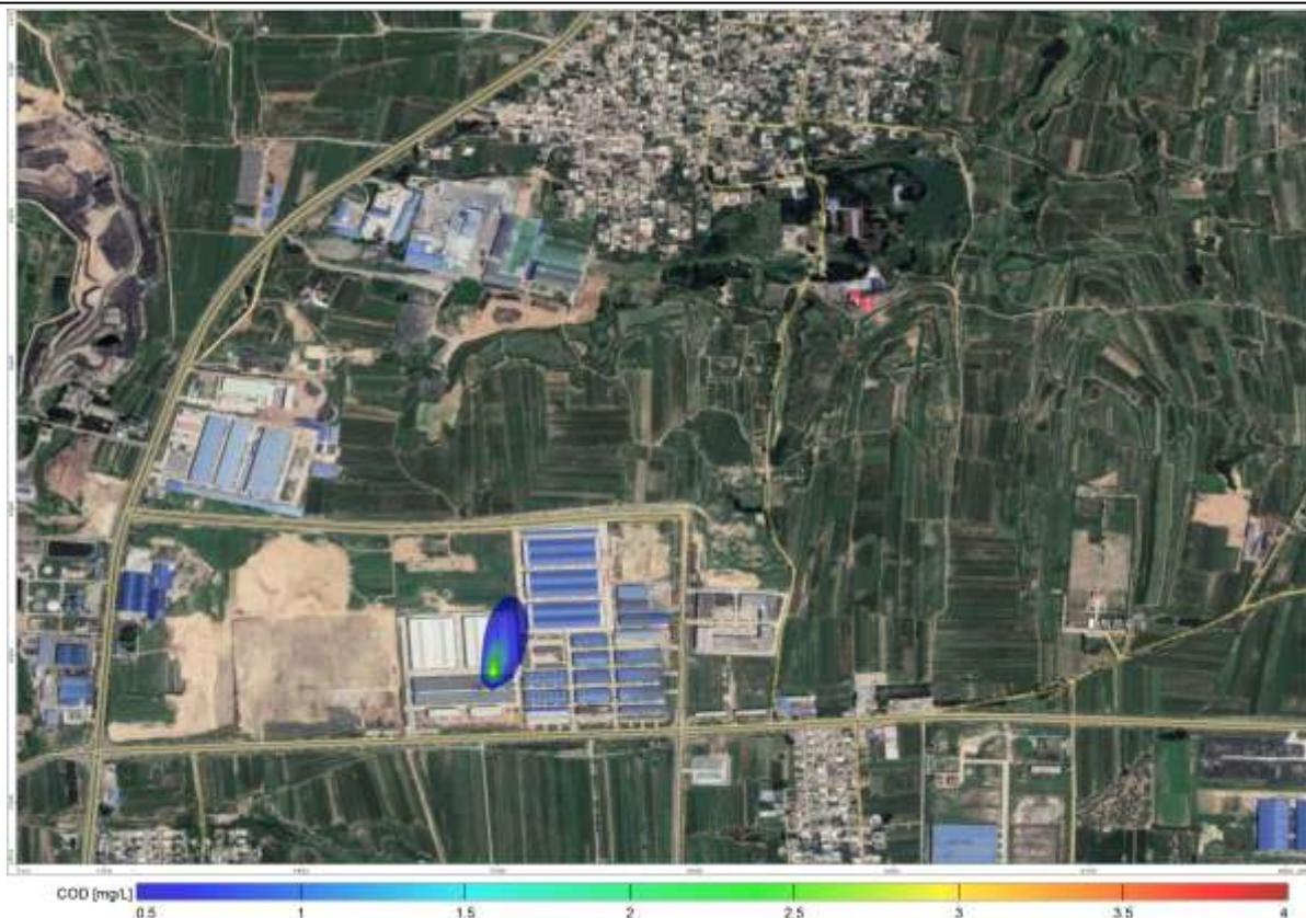
图 5-17 渗漏 1000d 地下水中 COD 运移预测图
